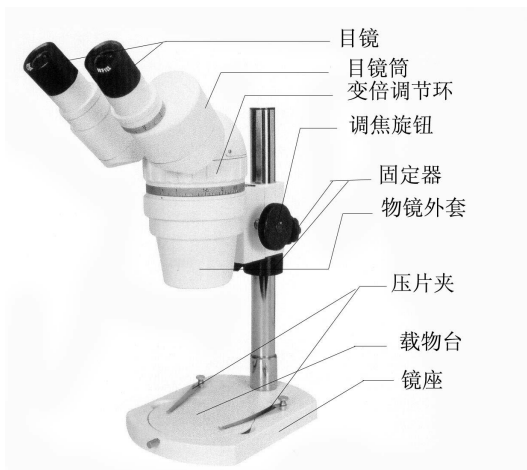
图 2-1 双目体视显微镜（外光源）构造图
